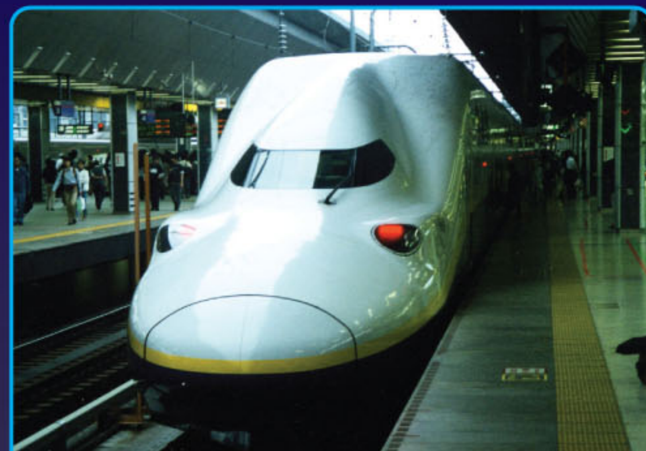
Ez a japán E4-es emeletes bejáróvonat 6720 kW teljesítményű motorvonat legnagyobb sebessége 240 km/h. Tokió, 2003. május
